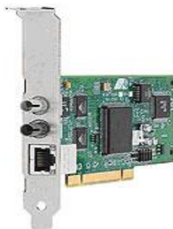
NIC ISA tích hợp RJ-45 và ST, SC để nối cáp quang.
