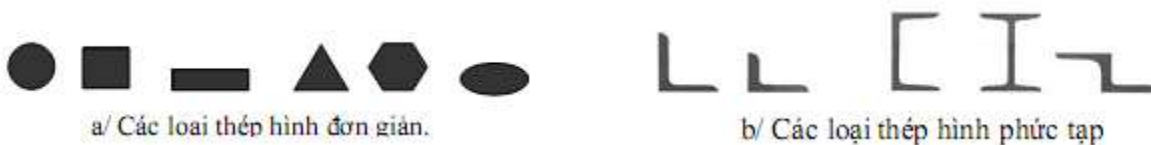
Hình 2.4 Tiết diện ngang một số sản phẩm cán
