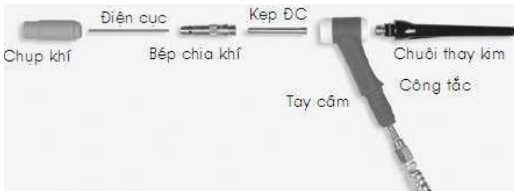
Hình 3.29. Mỏ hàn giải nhiệt bằng không khí
