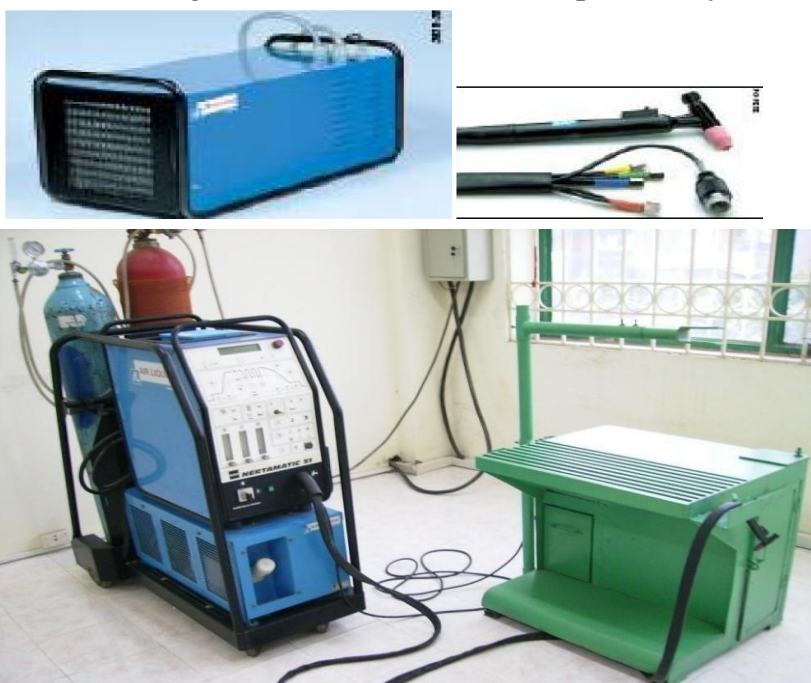
Hình 5.12: Thiết bị hàn plasma NERTAMATIC 51
