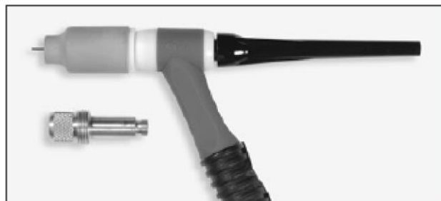
Hình 3.30. Mỏ hàn sử dụng ống hội tụ để giảm sự cuộn xoáy của dòng khí bảo vệ
