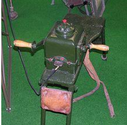
Hình 10.5. Máy phát điện quay tay của trạm thu phát vô tuyến (nhà bảo tàng quân sự Dubendorf)
