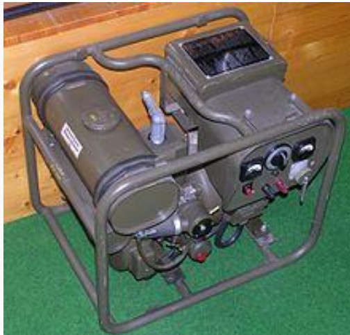
Hình 10.4. Máy phát điện động cơ nổ
