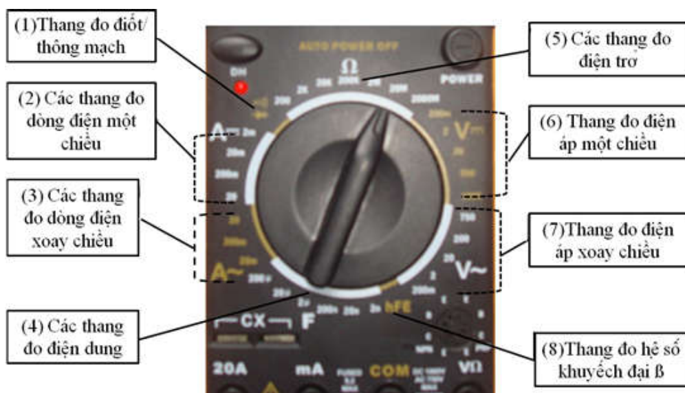
Hình 2.6. Hình ảnh đồng hồ vạn năng chỉ thị số
