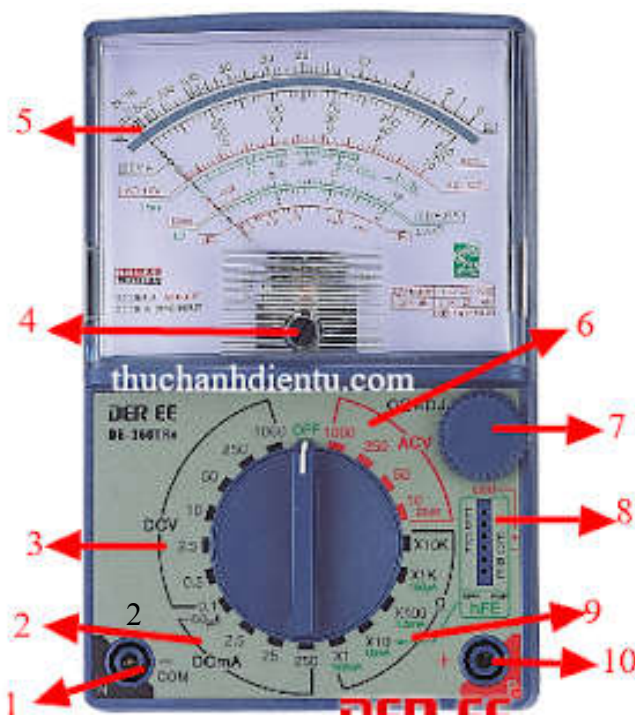
Hình 2.5. Hình ảnh đồng hồ vạn năng chỉ thị kim
