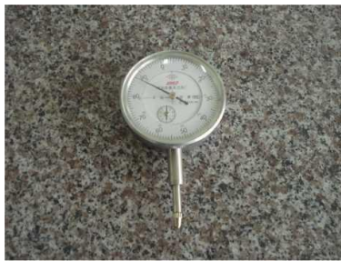
Đồng hồ đo biến dạng ngang (Biến dạng ké) độ chính xác đến 0,01 mm
