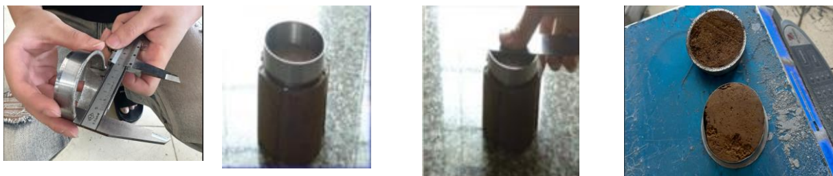
Hình 7.2. Thí nghiệm xác định dung trọng tự nhiên đất bằng dao vòng
