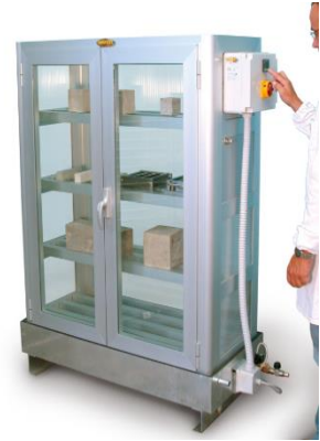
Hình 6-4. Bảo dưỡng mẫu trong tủ dưỡng hộ
