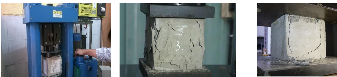
Hình 6-5. Nén mẫu bê tông
