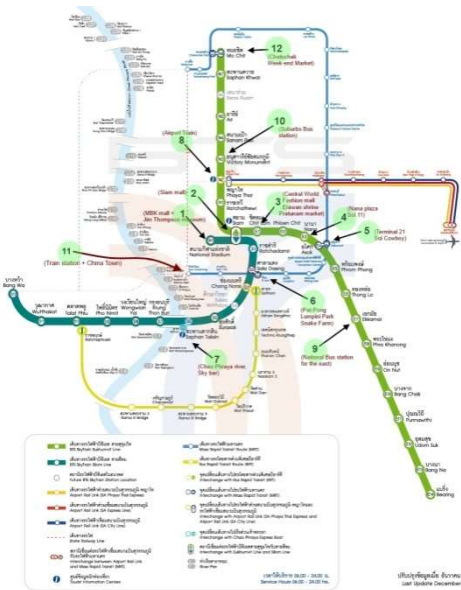
Hình 6: Sơ đồ tuyến hoạt động và ga chờ của hệ thống đường sắt trên cao tại Bangkok – Thái Lan
