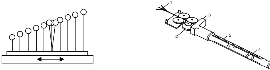
Hình 4.3.4. Xác định tần số dao động bằng con lắc quán tính.
