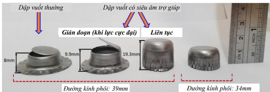
Hình 1.20. Khả năng biến dạng dẻo của dập vuốt thông thường và dập vuốt có rung động siêu âm hỗ trợ
