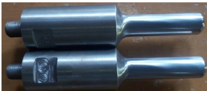
Hình 3.13. Kết cấu dụng cụ biến dạng dẻo dùng cho bộ phát rung KHS20-IP50-L
