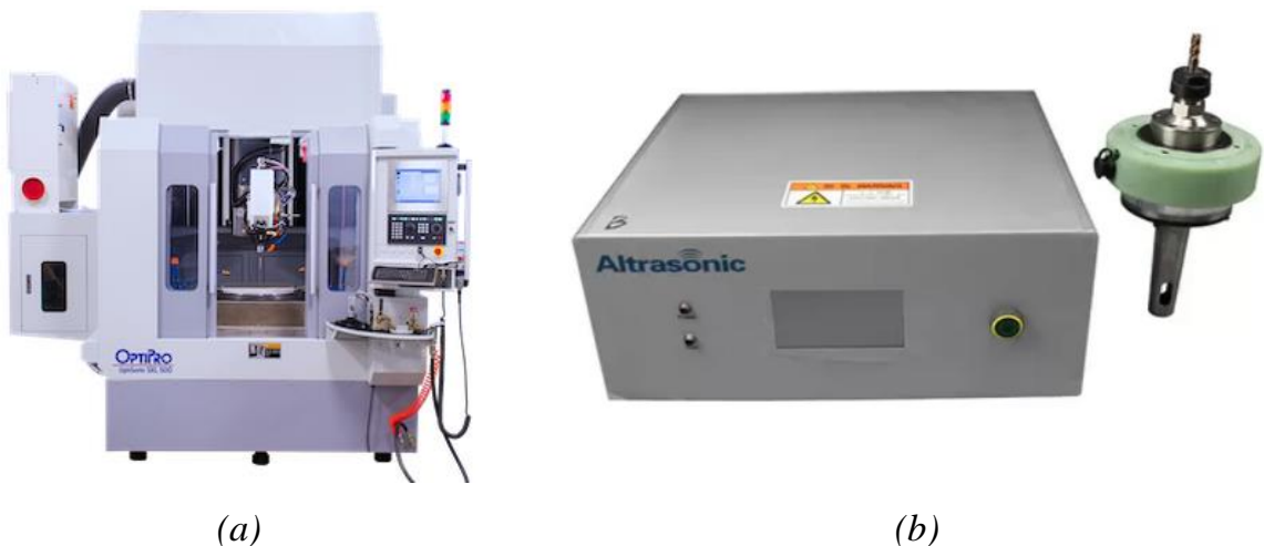
Hình 3.1. Trung tâm gia công siêu âm (a) và bộ dụng cụ gia công siêu âm (b)
