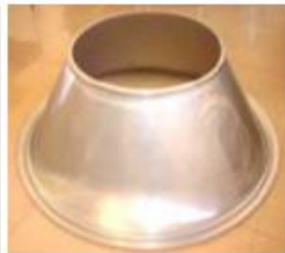
Hình 1.4. Một số sản phẩm điển hình gia công bằng phương pháp ISF
