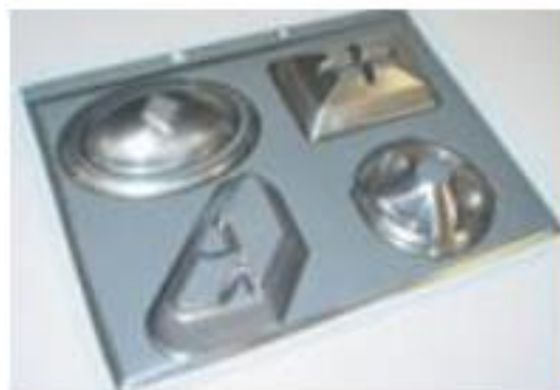
Hình 1.4. Một số sản phẩm điển hình gia công bằng phương pháp ISF
