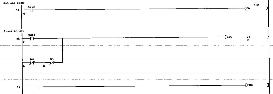
**Bài tập 3.** Khi ấn nút START(NO) hệ thống làm việc, băng tải vận chuyển thùng chạy. Khi thùng vào vị trí nhận sản phẩm, băng tải vận chuyển thùng dừng và băng tải vận chuyển sản phẩm chạy. Khi vận chuyển được 10 sản phẩm vào thùng thì băng tải vận chuyển sản phẩm dừng. Sau khi băng tải vận chuyển sản phẩm dừng được 10 giây thì băng tải vận chuyển thùng chạy để đưa thùng khác vào vị trí nhận sản phẩm . Muốn dừng hệ thống thì ấn nút STOP(NO).
