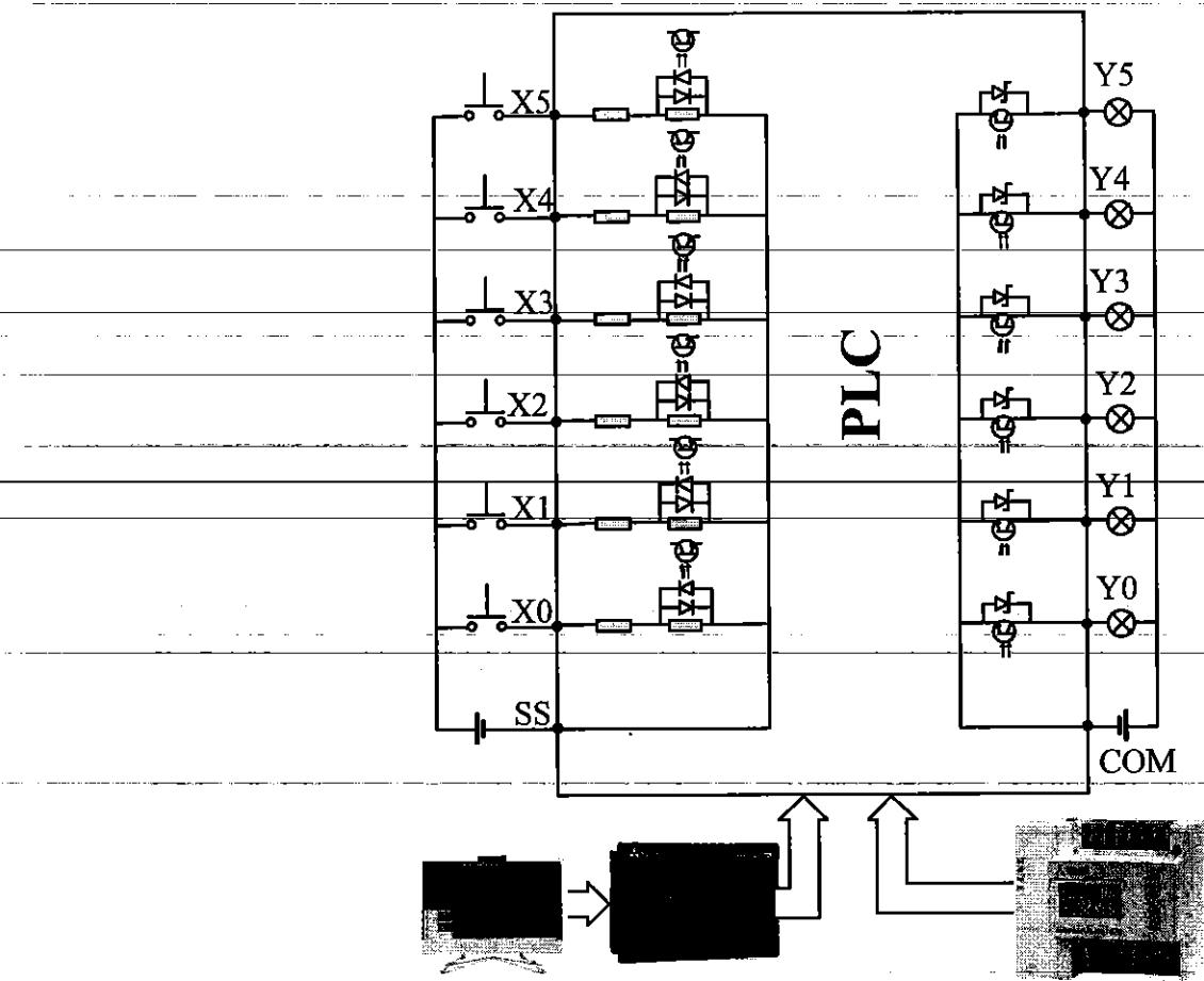
**Bài tập 1.** Thiết kế hệ thống điều khiển tự động vận chuyển và đếm sản phẩm vào thùng chứa có yêu cầu: Án nút Start(NO) băng tải chạy vận chuyển sản phẩm vào một thùng chứa, cứ được 10 sản phẩm thì băng tải vận chuyển dừng 5 giây rồi lại chạy tiếp tục. Khi án nút stop(NO) thì băng tải dừng làm việc.
