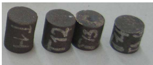
Hình 10. Mẫu vật liệu ma sát chế tạo bằng phương pháp ép nóng với nhiệt độ khác nhau
