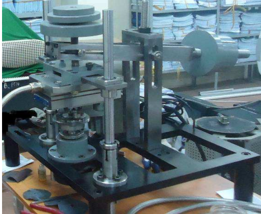
Hình 4. Máy xác định đặc tính ma sát - mòn được chế tạo bởi nhóm nghiên cứu
