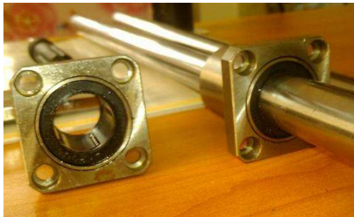
Hình 6. Ổ bi tuyến tính trong cơ cấu trượt đứng
