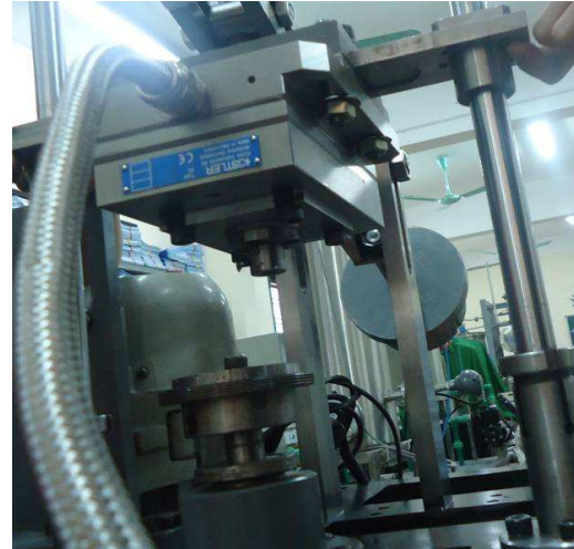
Hình 7. Cảm biến đo lực được lắp trên máy TN
