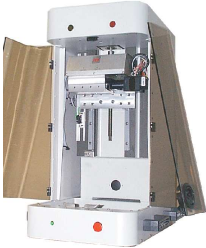
Hình 2. Thiết bị đo ma sát-mòn-bôi trơn CERT-USA của Học viện Kỹ thuật quân sự
