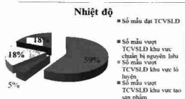
Hình 5. Biểu đồ tỉ lệ phần trăm số mẫu đo nhiệt độ vượt TCVSLĐ theo các khu vực sản xuất trong 5 năm (2011 – 2015)
