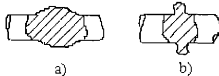
Hình IV.4- Mối hàn tiếp xúc a) Hàn điện trở; b) Hàn nóng chảy
