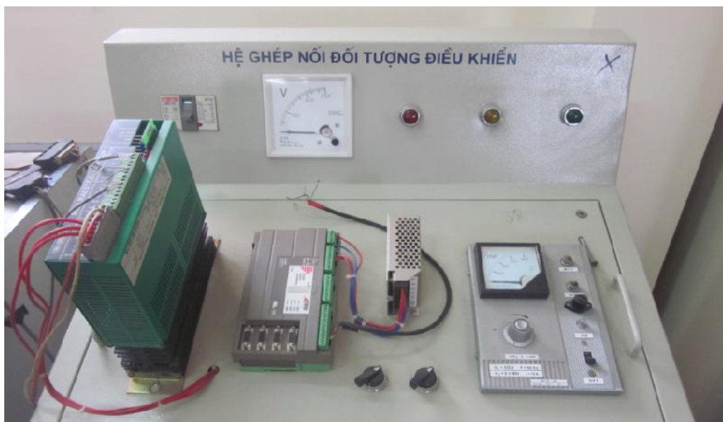
Hình 4.8: Hệ thống ghép nối máy tính với hệ truyền động (động cơ)
