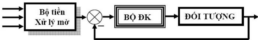
Hình 3.12: Bộ điều khiển mờ lai có khâu tiền xử lý mờ
