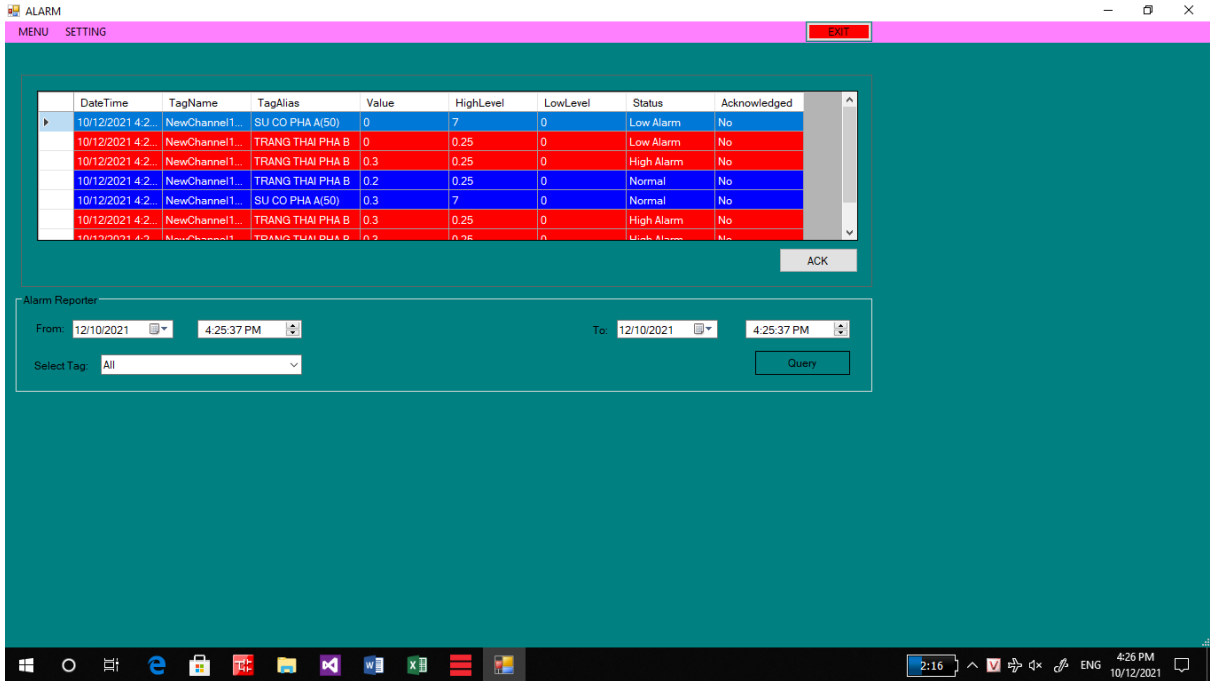
Hình 3.12 Giao diện thu thập dữ liệu cảnh (Alarm) của trạm 110kV Tây Thanh Hóa trên phần mềm Visual Studio
